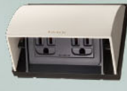
WKF2105W(白色) 掀蓋式防雨插座 (5.5 mm2絞線用附接地極雙插座) 15 A 125 V AC
