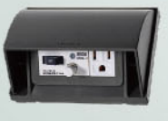
WKF2106B(黑色) 掀蓋式防雨插座 (漏電保護附接地極插座) 漏電斷路組件：15 A 110 V AC 60 Hz 靈敏度電流：15 mA (動作時間0.1秒以內) (不動作電流7.5 mA) 接地插座部： 15 A 125 V AC ※限定室內使用
