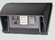
WKF2114B(黑色) 掀蓋式防雨插座 (附接地極插座・插座電源控制開關) 插座：15 A 125 V AC 開關：15 A 300 V AC
