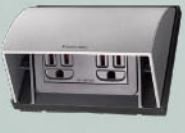
WKF2105S(銀色) 掀蓋式防雨插座 (5.5 mm2絞線用附接地極雙插座) 15 A 125 V AC
