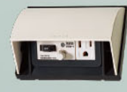
WKF2106W(白色) 掀蓋式防雨插座 (漏電保護附接地極插座) 漏電斷路組件：15 A 110 V AC 60 Hz 靈敏度電流：15 mA (動作時間0.1秒以內) (不動作電流7.5 mA) 接地插座部： 15 A 125 V AC ※限定室內使用
