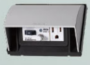
WKF2106S(銀色) 掀蓋式防雨插座 (漏電保護附接地極插座) 漏電斷路組件：15 A 110 V AC 60 Hz 靈敏度電流：15 mA (動作時間0.1秒以內) (不動作電流7.5 mA) 接地插座部： 15 A 125 V AC ※限定室內使用
