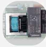
22 電流檢測器保護電路板 過載時停止壓縮機
