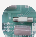
41 風扇馬達保險絲，阻斷 過大電流，避免機體受損
