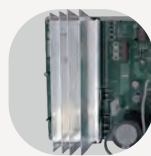
6 散熱片構造與過熱防止
