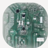
23 主機板AC高電壓/ DC低電壓採隔離設計
