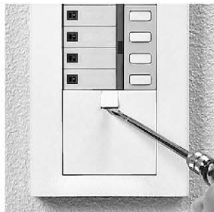
1 鬆開設定單元的蓋板螺絲，將蓋打開。
