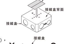
2 接線盒及配線管的方向會依照 地板插座安裝方向所限制(如右圖), 請務必確認方向後再行施工。
