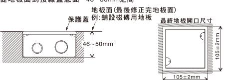
が泥灌漿後, 敲開保護蓋, 取下螺絲。 (敲開安裝孔時,為避免受傷請配戴護具。)
