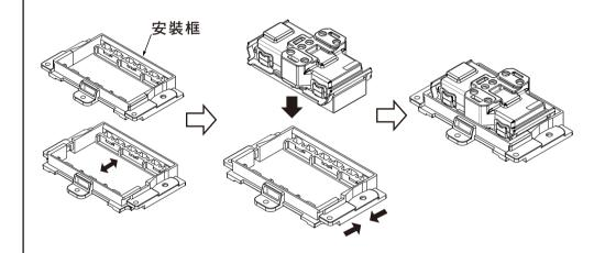
2 將安裝框依照方向①嵌入地板外蓋框架後,再朝方向②向下壓緊
