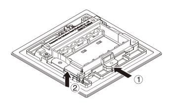
① 安裝框為滑動式,將安裝框拉開後,將器具放入安裝框後並 將安裝框壓緊。
