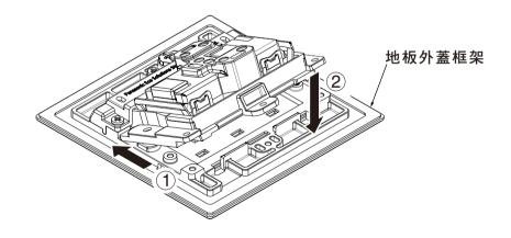
3 使用平頭螺絲(M3x5)x3將安裝框鎖付於地板外蓋框架。 ※建議適當旋緊轉矩:0.6N·m~0.8N·m
