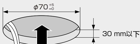
將安裝螺絲順時鐘方向旋轉時、夾具會依箭頭方向旋轉至底部後，固定於天花板上。
