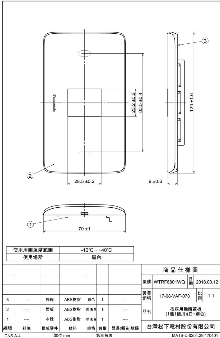
設備名稱:插座用瞬瞬蓋板(1連1個用)(白+銅色) 型號(型式):WTRF6801WQ
